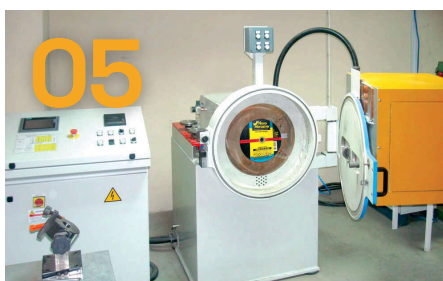
05 Test di carico laterale
