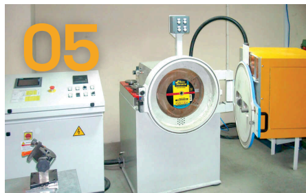
05 Ensayo de carga lateral
